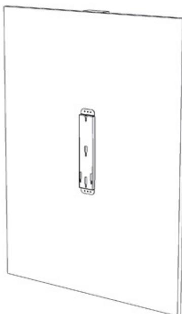
4. Insérez les vis du boîtier dans le boîtier, comme illustré. Serrez les vis jusqu'à ce qu'environ 2 mm du pas de vis soient visibles.
